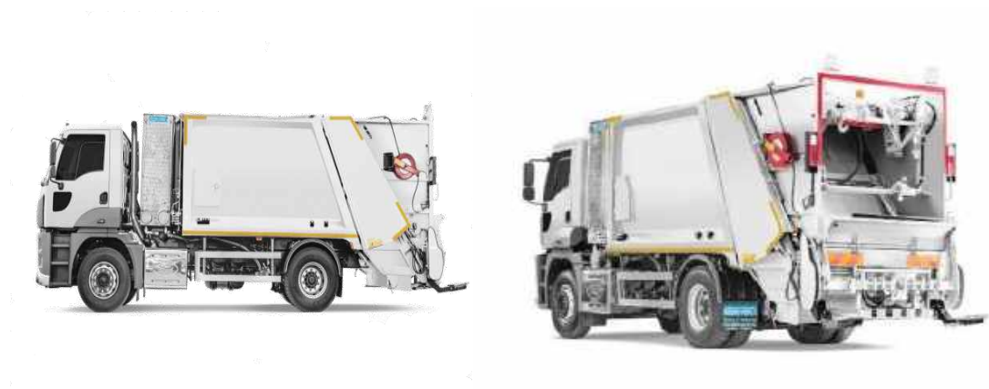
Рис. 17. Сміттевоз Ford Truck з обладнанням для миття контейнерів Hidro Mak - мобільна мийка контейнерів на базі вантажного автомобіля:
