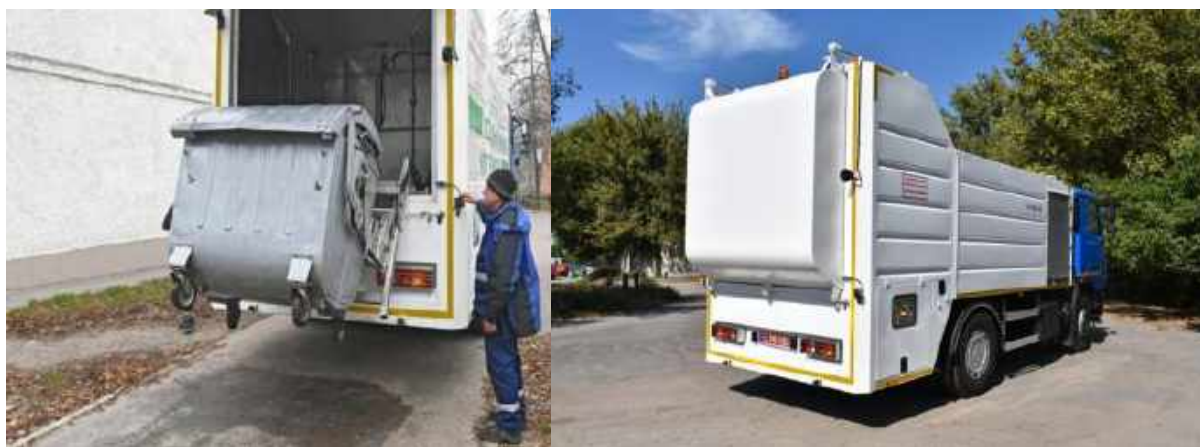
Рис.18. Мобільна мийка контейнерів АТ МК-0103 на базі шасі МАЗ 5340С2
