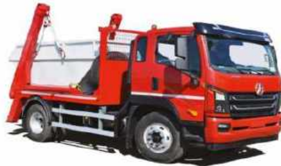
Рис. 39 Сміттєвоз СВ302.3 на шасі Dong Feng
