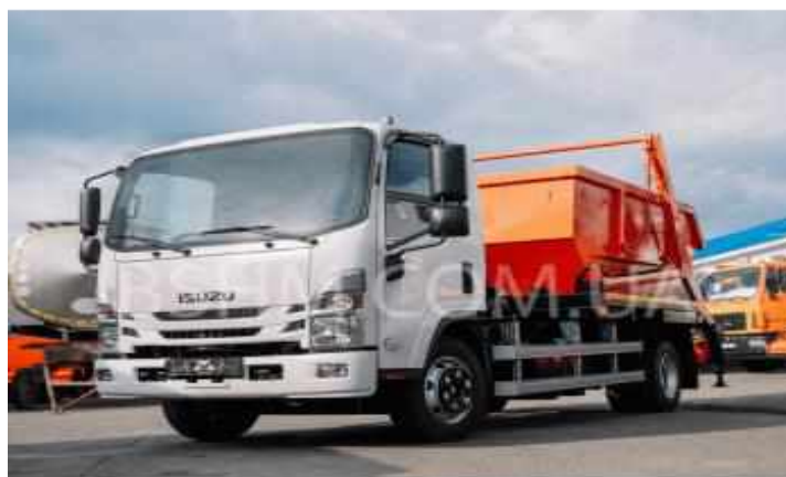
Рис. 40 Сміттєвоз СВ302.1 на шасі ISUZU
